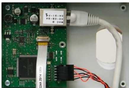
Připojení na desce IP kontrolní skříňky
